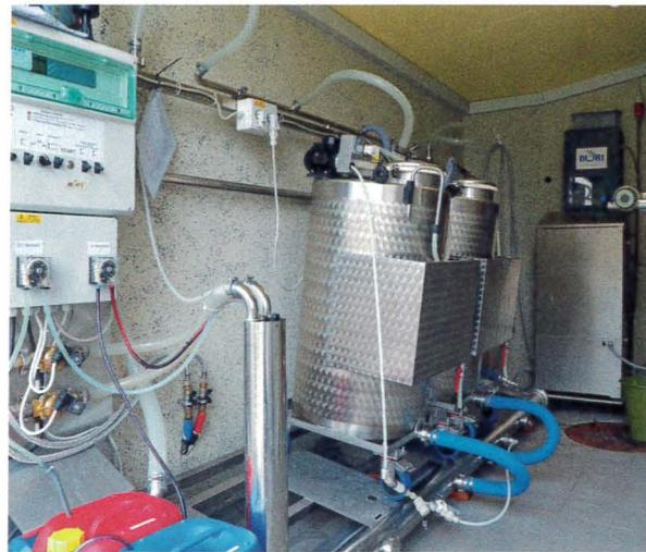
Ein Anbau auf dem Betrieb der Familie Peter in Steffisburg BE war notwendig, um die ganze Anlage unterzubringen. Die Spülstation (vorne) reinigt die beiden Wechsel-Tanks (Mitte) und den Pasteur (hinten).
