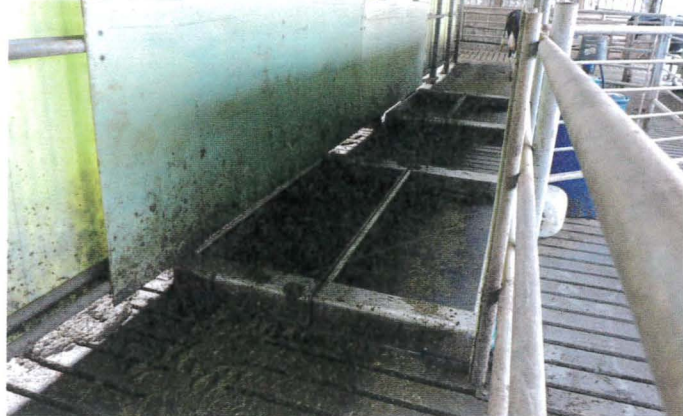
Automatisches Klauenbad mit geschlossenen Seitenwänden und zwei Wannen nacheinander.
