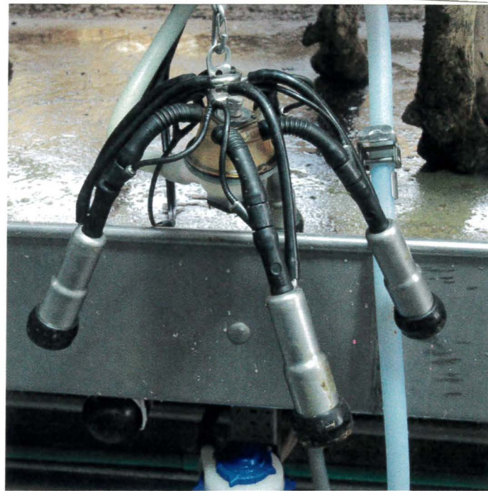
Das AirWash-Plus-System kann an jedem Melkzeug nachgerüstet werden, somit ist kein Melkzeug-Wechsel notwendig.
