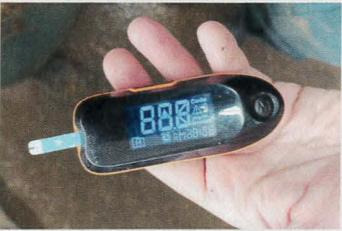
4. Nach Herstellerangaben: Einsetzen des Teststreifens zum Start des Gerätes
