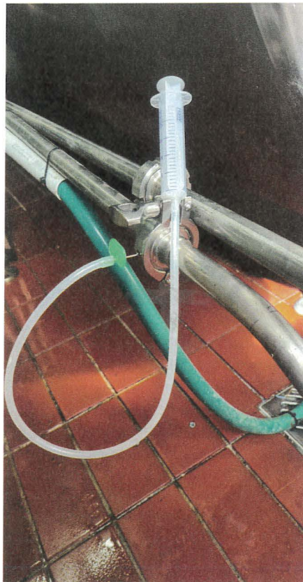
Entnahme einer Stufenprobe an der Milchdruckleitung mithilfe einer Kanüle und einem speziell angefertigten Kupplungsstück für Milchdruckleitungen. Fotos: Lüttel
