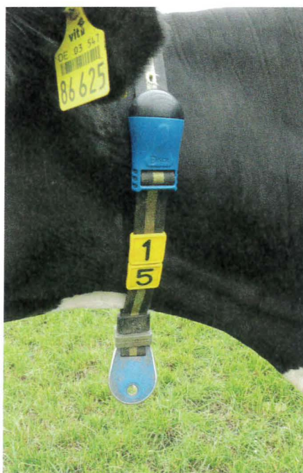
Die Sensoren am Halsband der Kühe überwachen das gesamte Fressverhalten und übernehmen die Brunsterkennung.
