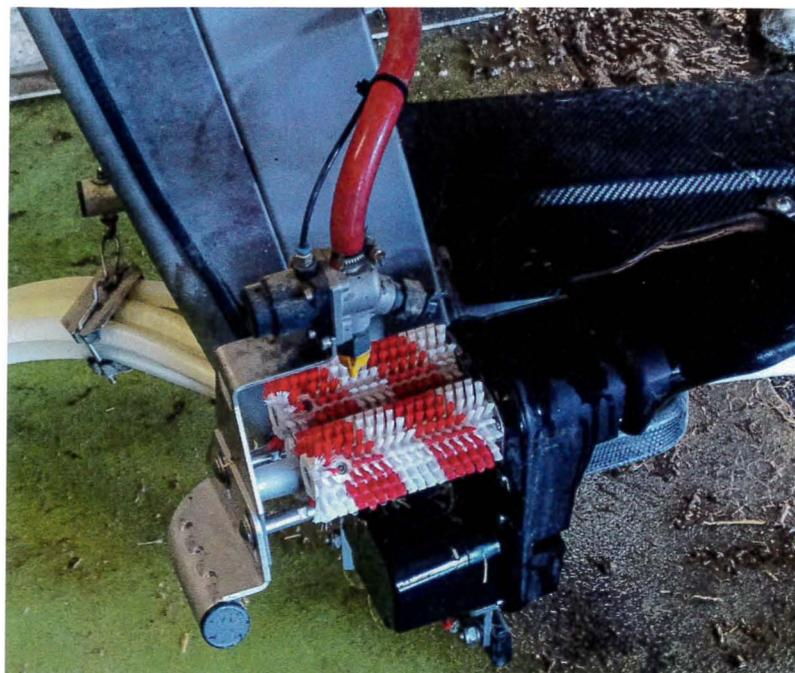
Es gibt mehrere Arten von Sprühdüsen. Diese Schlitzdüse war bei Landwirt B. auf dem Betrieb verstopft.
