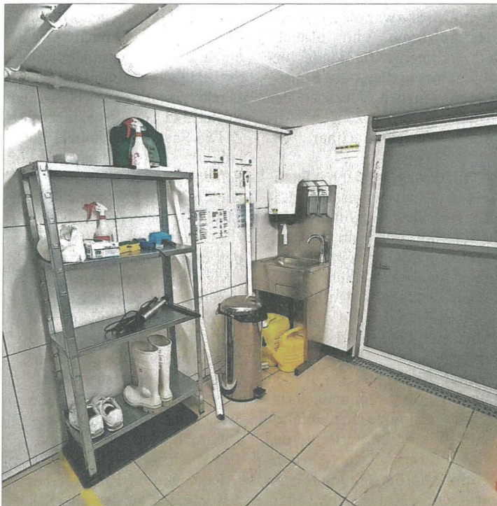
Hygieneschleuse zur Molkerei: Handwaschgelegenheit und Mittel zur Schuhdesinfektion. Die Fliegentüre im Eingang erledigt beim Trocknen wichtige Dienste.
