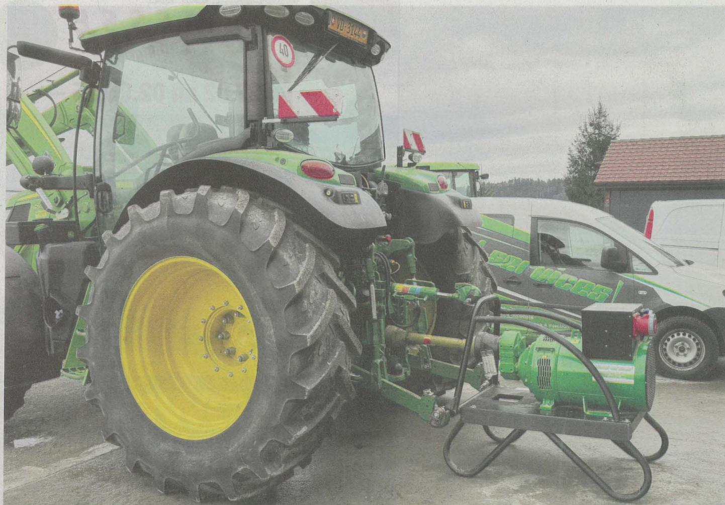
Selon Vincent Dousse, pour une PTO de 100 KVA, la puissance minimale du tracteur doit être de 140 CV.
