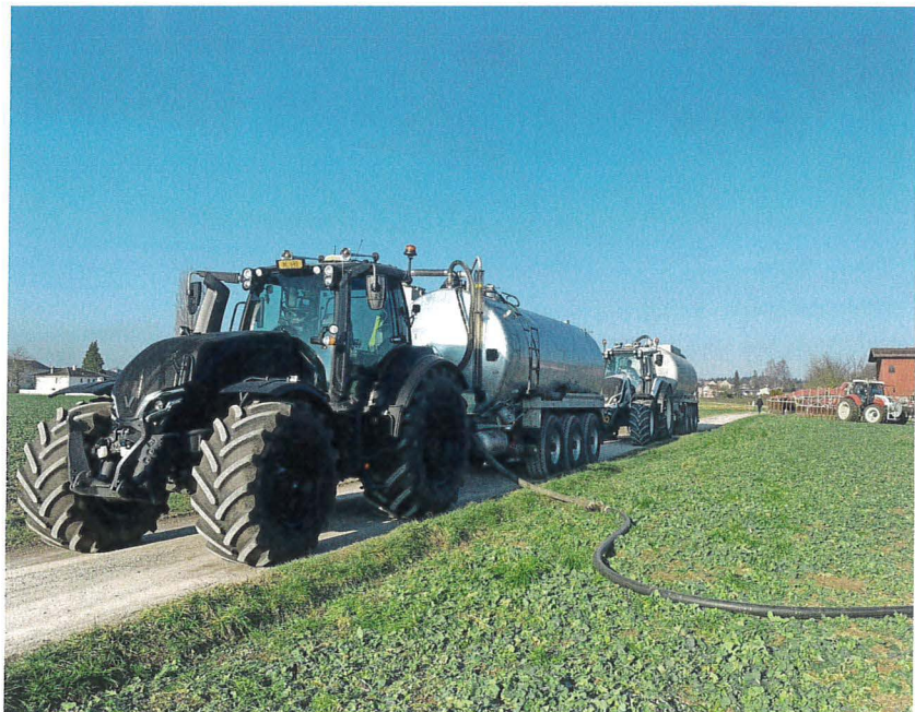
Das Lohnunternehmen Hofstetter transportiert die Gülle an den Feldrand für die Verschlauchung. Wenn möglich, wird ab Loch verschlaucht.
