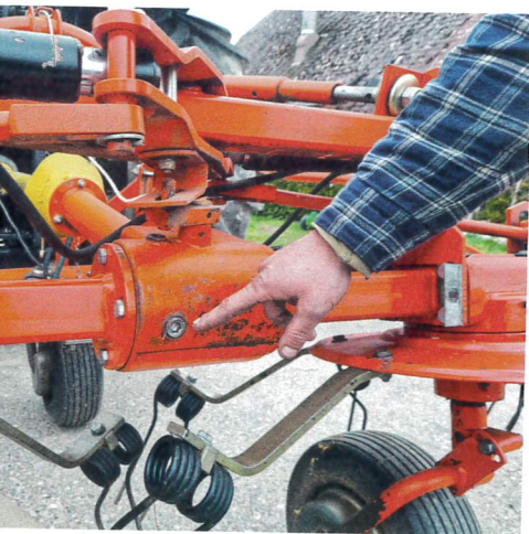
Das Ölniveau im Verteilgetriebe kontrollieren.
