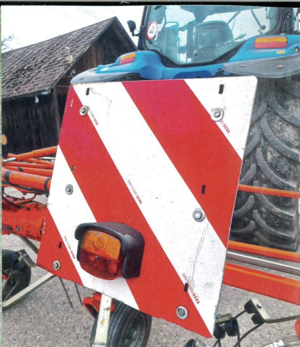
Die Kontrolle von Beleuchtung und Signaltafeln gehört zur Maschinenpflege.
