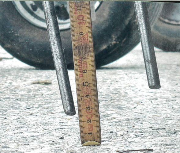
Grundeinstellung mit Zinkenabstand von 2,5 bis 3 Zentimeter auf festem Boden.
