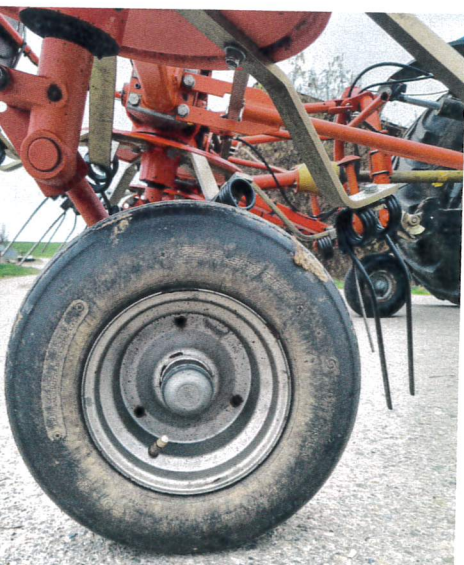
Reifendruck an allen Rädern kontrollieren. Spröde Reifen ersetzen.
