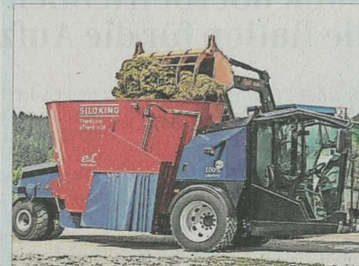
Der TruckLine e.0 eTruck 1408 wird mit einem Akku angetrieben. (Bild: zvg)
