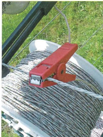
Zur schnellen und sicheren Verbindung bei Litzen eignen sich isolierte Edelstahlkrokodilklemmen.
