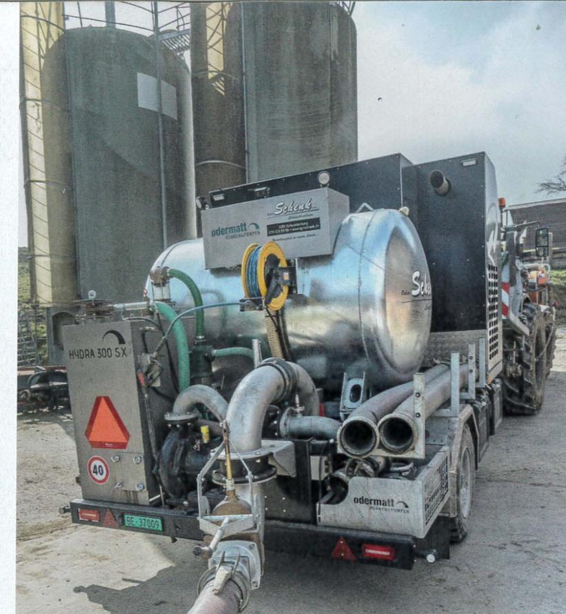
Mit dieser Einrichtung ist die Verschlauchung im Einmann-Verfahren möglich. Die Pumpenfernsteuerung erfolgt von der Traktorkabine aus.
