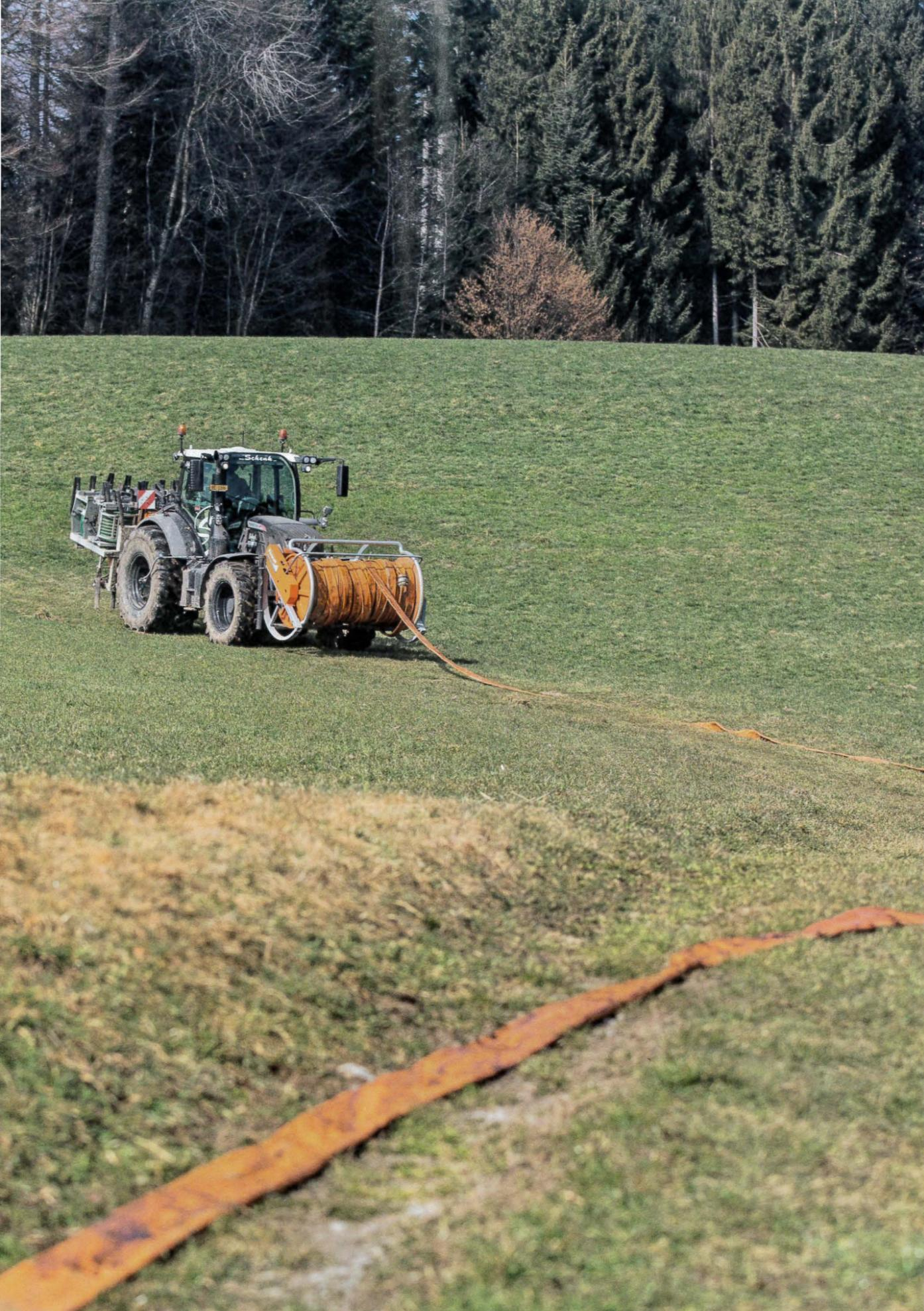
Auf dem Haspel sind 100 Meter lange Schläuche aufgerollt. Diese werden gezielt abgerollt, damit von der am weitesten entfernten Ecke aus mit dem Güllen begonnen werden kann.
