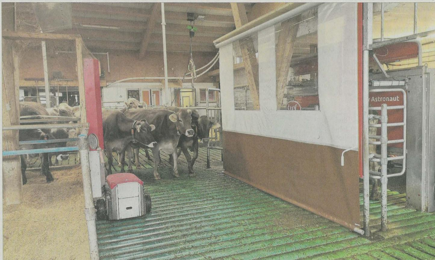
Beim Astronaut A5, bei dem die Kühe gerade durch die Melkbox gehen, kann die Seite geschlossen werden. (Bild: zvg)
