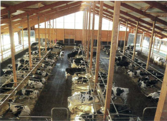
Sechsstufiger Liegeboxenlaufstall mit zwei außen liegenden Futtertischen, Hochboxen und Spaltenboden.
