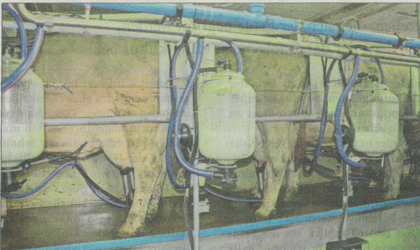
Streuströme im Melkstand können zu Ungeduld beim Melken oder vermehrtem Abschlagen des Melkzeugs führen. (Bild Aline Küenzi)
