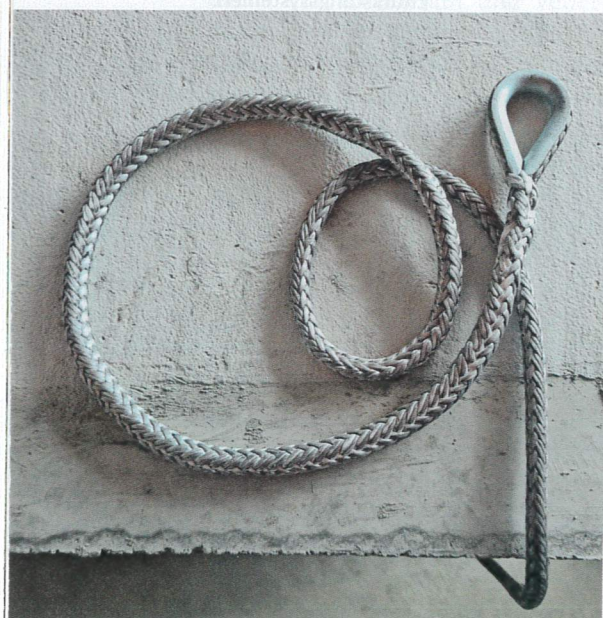
Kunststoffseile haben weniger Verschleiss, aber sie dehnen sich noch zu stark für den Praxiseinsatz.
