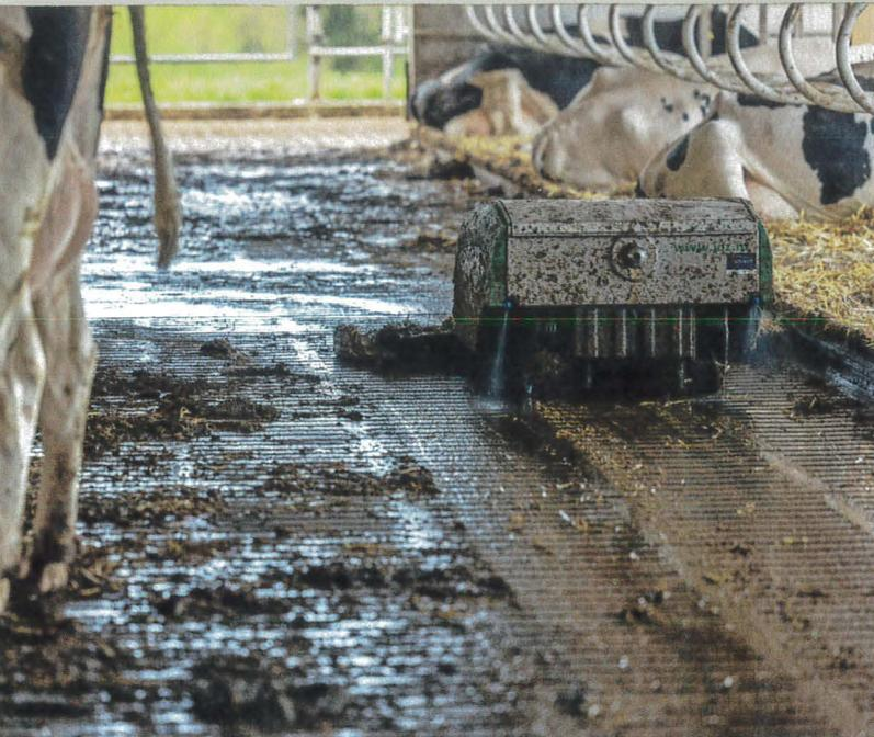
Ein Entmistungsroboter sorgt für trockene, saubere Laufgänge und somit für weniger Ammoniak-Emissionen. Der Roboter reinigt tagsüber alle zwei Stunden.
