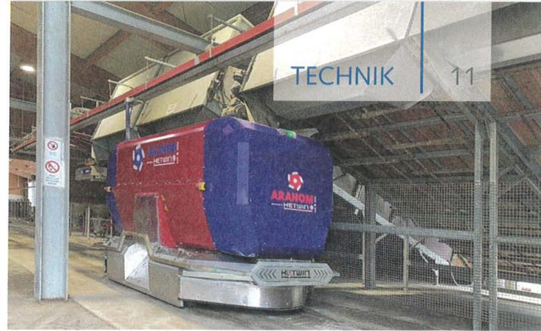
Der Hetwin Aranom ist mit 4 m<sup>3</sup> der größte autonom fahrende Fütterungsroboter.
