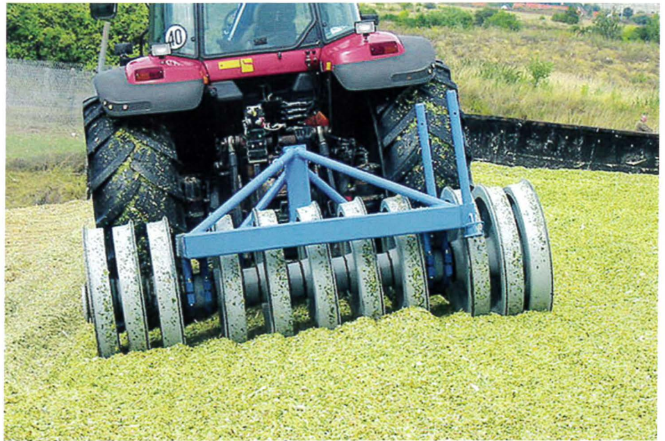
An einem Gestell montierte schwere Eisenbahnräder sind der Klassiker bei der Siloverdichtung. Hier ein Modell von Olbert mit elf Waggonrädern.
