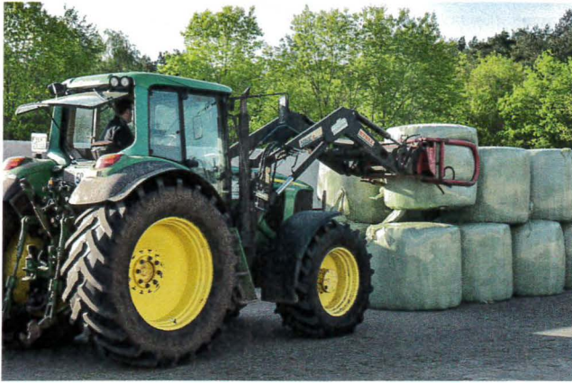
△ Beim Transport müssen Schäden an der Folie und Verformungen der Ballen vermieden werden, damit kein Gärgas austreten kann.
