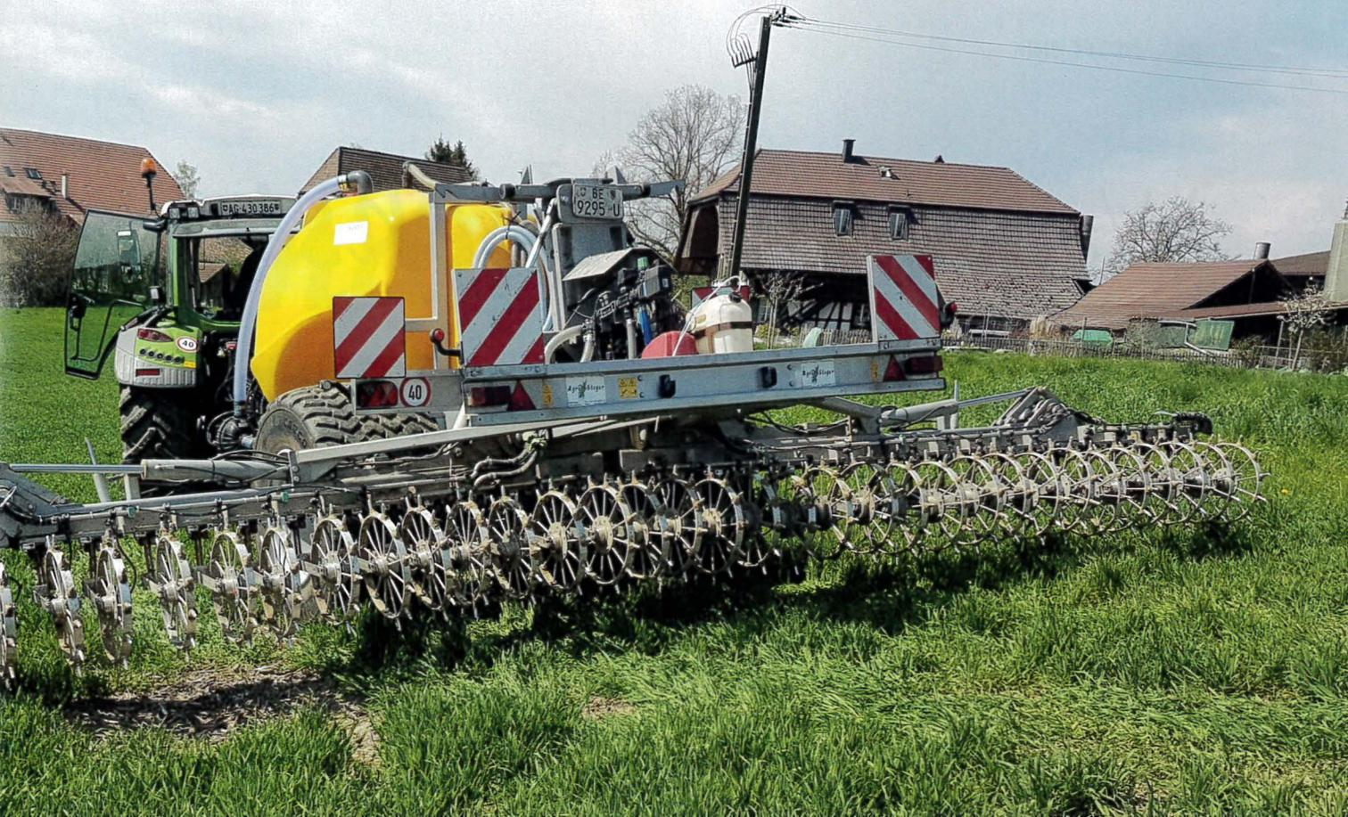
Der Flüssigdünger aus der ARA ist eine Ammonium-Schwefel-Lösung. Guido Steger und Martin Häberli bringen diese ASL-Lösung mit einem speziell dafür konstruierten Gerät mit den Stachelrädern direkt 4 bis 8 cm tief in den Boden ein.
