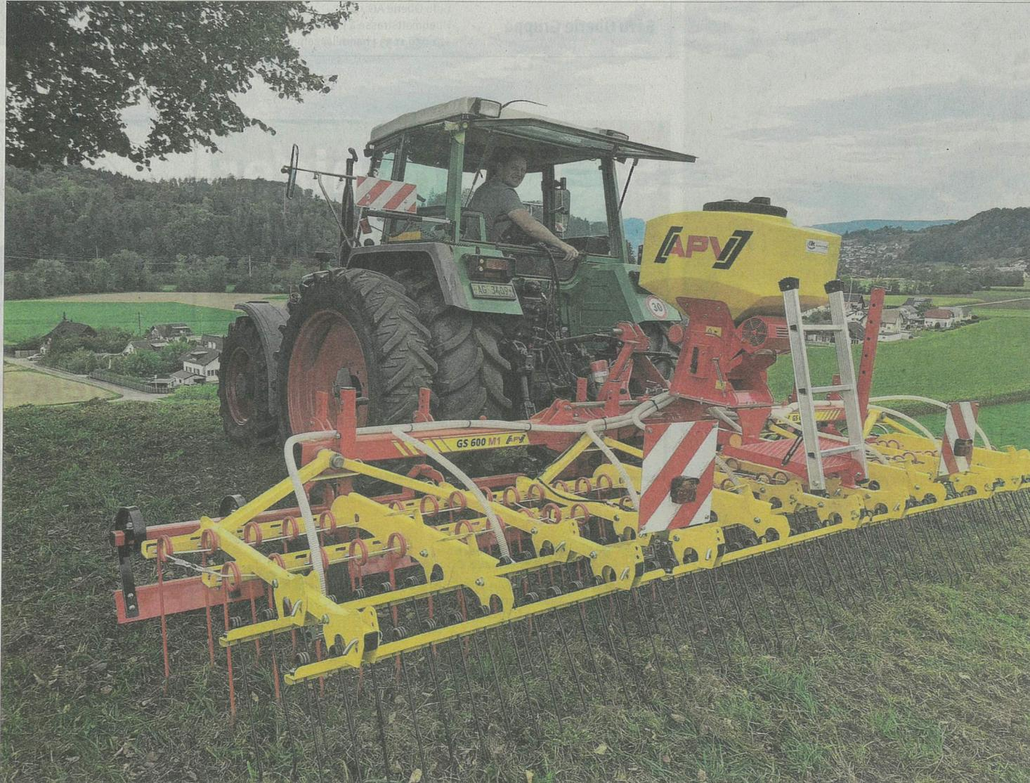
Ein 6 m breiter Sästriegel von APV für die kombinierte Bearbeitung und Übersaat. (Bild: Liebegg)
