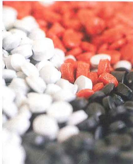
Aus einem Mix diverser Plastikabfälle entsteht neues Kunststoffgranulat.
