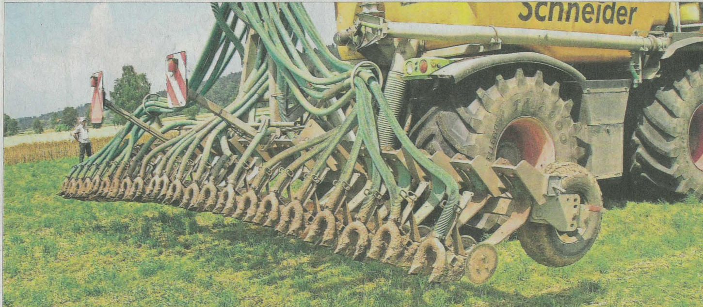
Beim Schlitzdrill wird ein grosser Teil der Gülle eingedrillt. Die mit Gülle verschmutzte Fläche ist minimal. (Bild: zvg)
