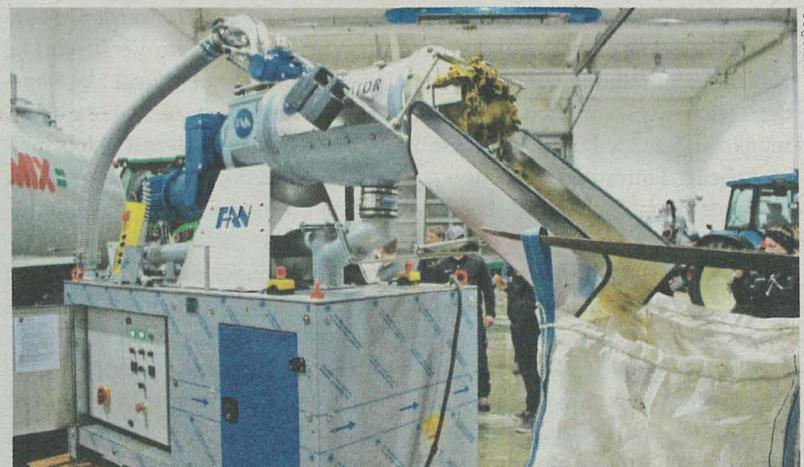
**Gülle mechanisch trennen:** Nicht nur Landwirte auch Biogasanlagenbetreiber nutzen z. B. den Pressschnecken-Separator, um damit Gülle und Gärreste in ihre festen und flüssigen Bestandteile zu separieren.
