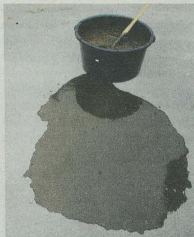
**Dick oder dünn:** Sehr anschaulich ist auch die Demonstration der unterschiedlichen Fließigenschaften von normaler und separierter Dünngülle auf einer normalen horizontalen Betonfläche.
