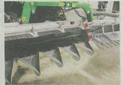
**Weder Schuh noch Schlauch:** Der Schleppfixverteiler hat weder Ablaufschläuche noch rotierenden Verteilkopf. Der Güllestrahl wird auf die V-förmigen, beweglichen Verteilkufen geleitet.
