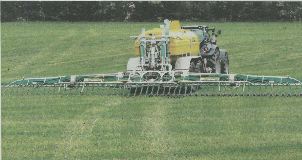
**Ziel der Gülleausbringung im Grünland: Bodennah und damit emissionsarm und möglichst wenige Güllewürste.** Dazu gibt es von den Herstellern diverse Techniklösungen. Im Bild linke Seite normale Schleppschuhverteiler, rechts mit zwei Ausläufen pro Schlauch.
