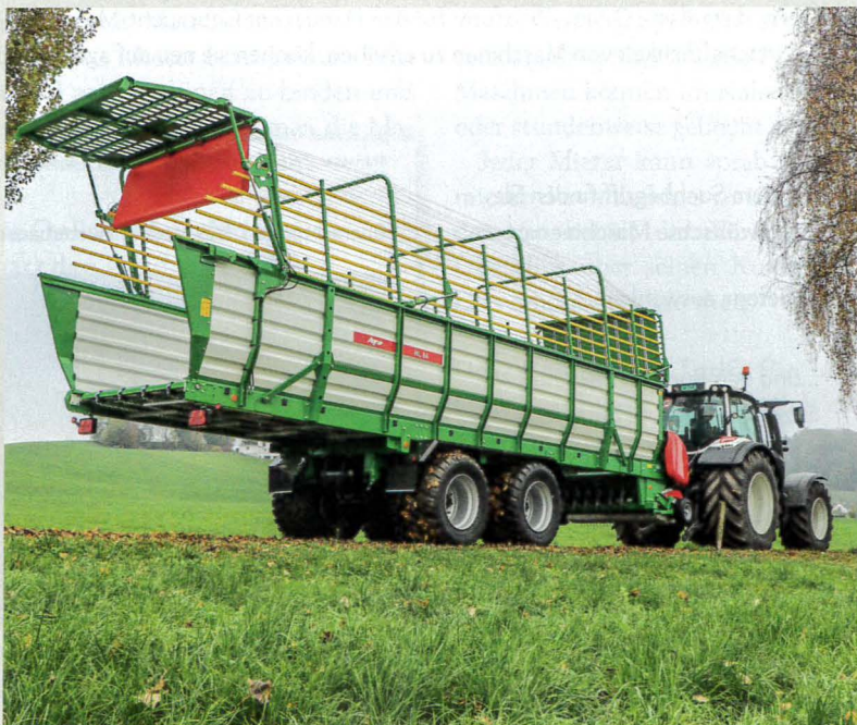
Der HL84 von Agrar fasst 84 Kubikmeter und hat eine Gesamtlänge von 11,6 Metern. Das Fahrwerk ist gefedert und gelenkt.
