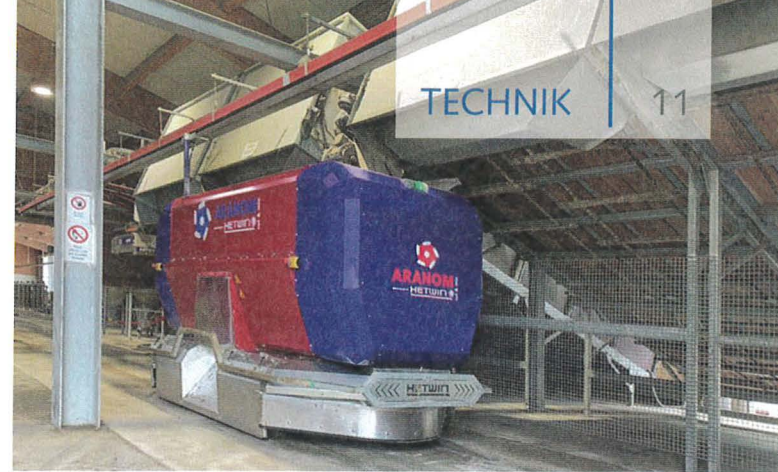
Der Hetwin Aranom ist mit 4 m 3 der größte autonom fahrende Fütterungsroboter.
