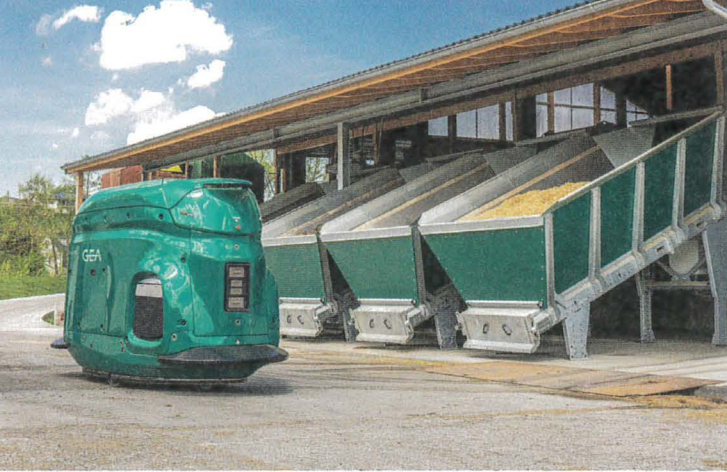
Der GEA Dairyfeed F4500 orientiert sich mit einem elektronischen Kompass und kann so jederzeit seine Position lokalisieren.
