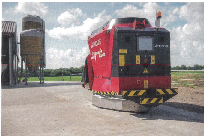
Der Trioliet-WB-Akkuroboter lädt seinen Akku in der Futterküche an einer Stromschiene – auch während des Beladens und Mischens.
