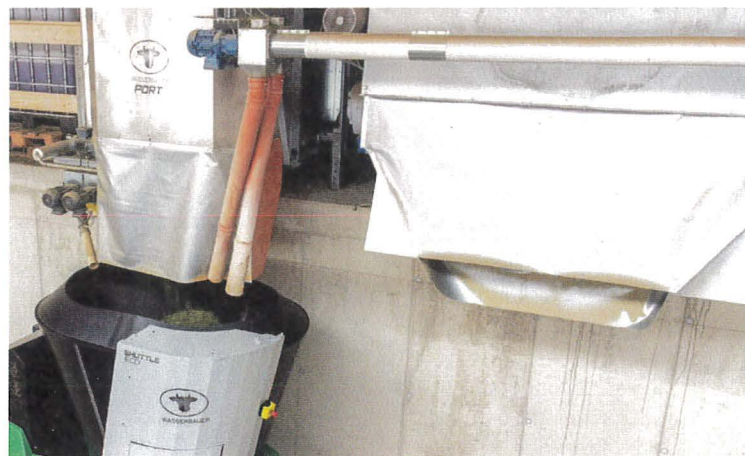
Die Ports von Wasserbauer für die Futterlagerung gibt es in verschiedenen Ausführungen mit Größen von 8 m 3 bis 80 m 3 .
