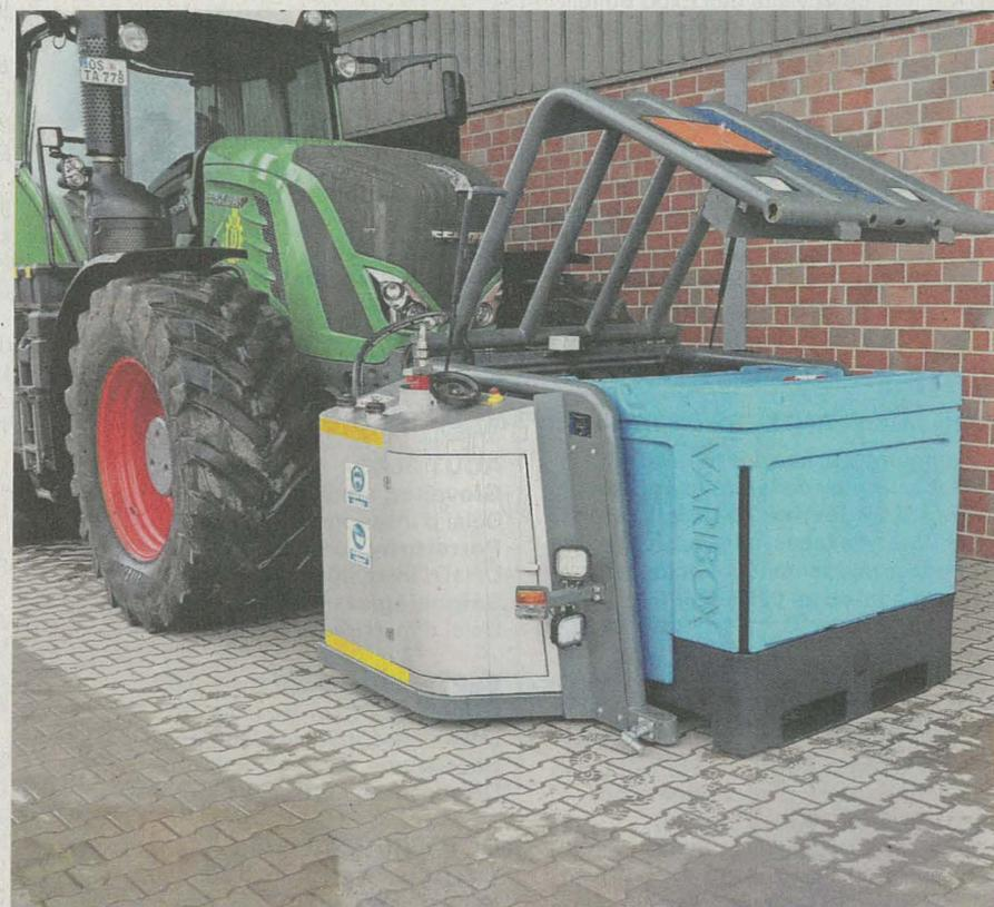
**Le tank frontal comprend notamment les réservoirs à acide sulfurique et à eau, une caméra ainsi qu'un dispositif d'éclairage.**
