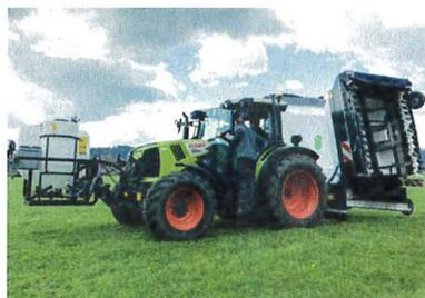
Das kameragesteuerte Präzisionsprüfgerät ermöglicht eine Behandlung von Anbaukulturen wie Raps, Zuckerrüben oder Buschbohnen. Zusätzlich lässt sich die Blacke gezielt mit Herbiziden behandeln. Mit EcoRobotix kann der Einsatz von Pflanzenschutzmitteln um bis zu 90 Prozent reduziert werden.
