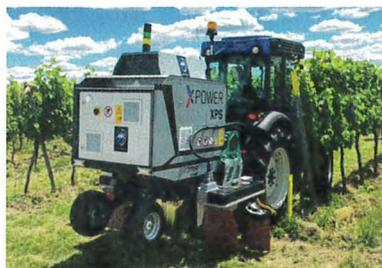
Die Technologie von xPower kommt im Obstbau zur Anwendung. Sie vernichtet Unkraut bis in die Wurzel mit elektrischen Ladungen. Dabei wird die Dosis elektrischer Energie via Elektroden auf das Pflanzengewebe des Unkrauts übertragen.
