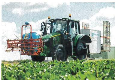
Die Technologie von Crop.zone zerstört Unkraut mit elektrischen Ladungen und kommt ohne chemisch-synthetische Pflanzenschutzmittel aus. Die Leitsubstanz reduziert den Energieverbrauch des Verfahrens deutlich. Zurzeit wird die Technologie in erster Linie in Kartoffelkulturen angewendet.
