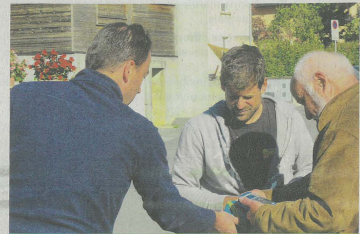
Johann Corninbœuf, Steve Mottiez et Jacques Piguet évaluant la différence de potentiel entre le lampadaire et le moteur du racleur.
